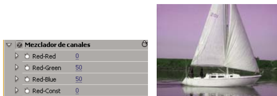
Se elimina toda la entrada de rojo del canal rojo y se añade el 50% del canal verde y el 50% del canal azul al canal rojo
