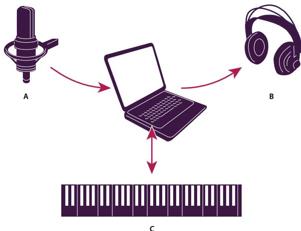
A. Las entradas de la tarjeta de sonido se conectan a fuentes como micrófonos y platinas. B. Las salidas de la tarjeta de sonido se conectan con altavoces y auriculares. C. Los puertos MIDI se conectan con dispositivos y aplicaciones MIDI.
